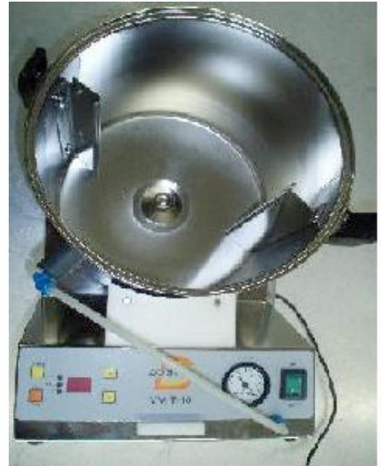
Abb.12: Vakuumentumbler Dorit VV-T-10 mit 2 Schikanen
